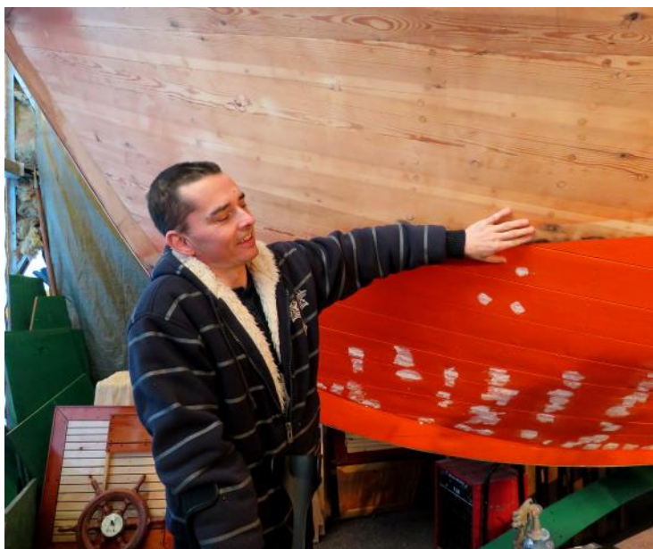
Anders klappar om sin klenod. Blymönja, godkänd att använda i detta sammanhang, är en del av metoden att få ett hållbart och långvarigt skydd. FOTO: Sture Claesson
