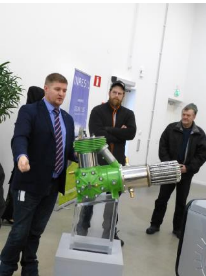
Daniel Walsh visar Inresol stirlingsmotor, som levererar 5,5 kWh el och 10-12 kWh värme. FOTO: Lennart A.
