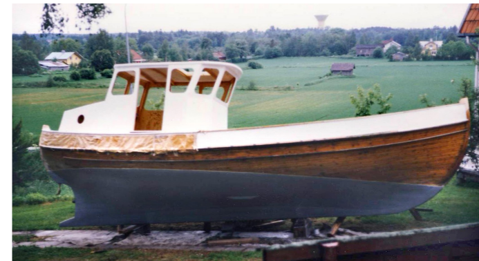
1987 blev det en stor renovering. Ny styrhytt, brädgången höjdes ca 10 - 15 cm och båten plastades i botten. Arbetet utfördes vid huset i Buberg med Söderhamns vattentorn vid horisonten.
