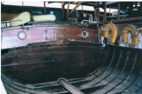
2002 i Sandarne. Invändig patina före renskrapning av ruff och skott. Utsidan renskrapad.
